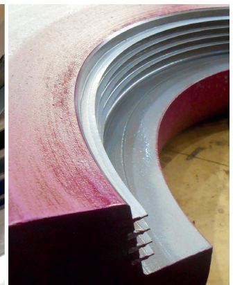
Dichtbänder auf Passmaß drehen und Bauteil mit Korrosionsschutzfarbe schützen
